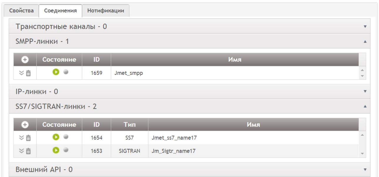
**Рис. 8.** Пример вкладки «Соединения» с линками SMPP и SS7/SIGTRAN
